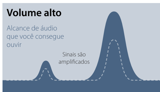
Sinal de audibilidade com configurações de volume alto e baixo
