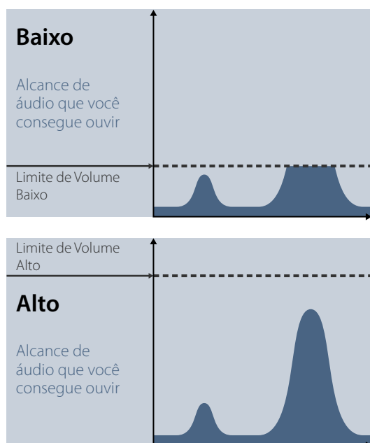
Sinal de audibilidade com diferentes configurações de Nível do Tom Limiar
